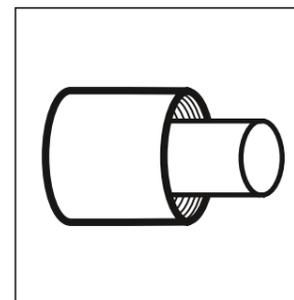
Повышенная герметичность соединений за счет клеевого слоя внутри трубки
